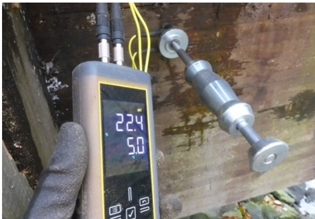
19 HOLZFEUCHTE LÄNGSTRÄGER
